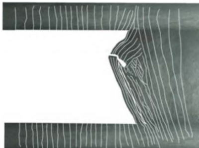
شکل ۱۵- شکست کمانشی در تونل حفر شده در سنگهای شیستوز
